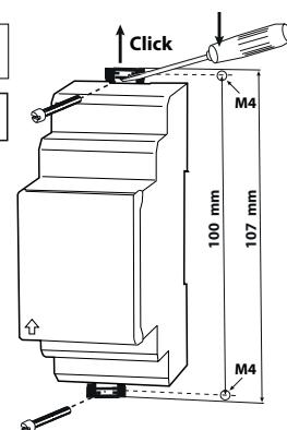
Die Frontplattenabdeckung ist an der mit dem Pfeil gekennzeichneten unteren Seite aufzuklappen.
